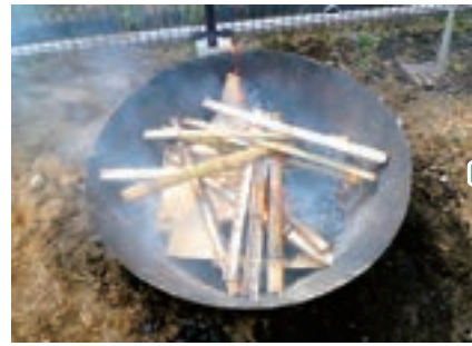
①M100 を使用し竹炭を作ります。 ボール紙と竹を入れて着火します。 炎が全体に行き渡るまで少し煙が出ます。
