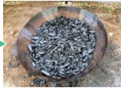
⑥火消し蓋・水・土・ドラム缶で消火します。 30分でドラム缶1個分の炭が出来ます。
