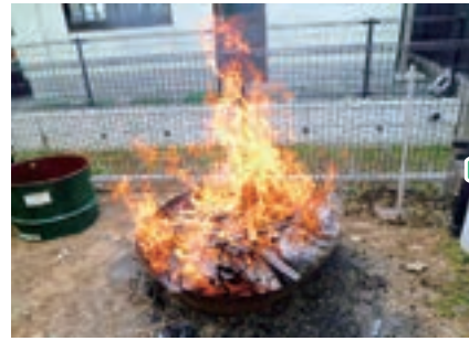
④炭化中です。炭化器がおきでいっぱいになってきたら投入を止めます。
