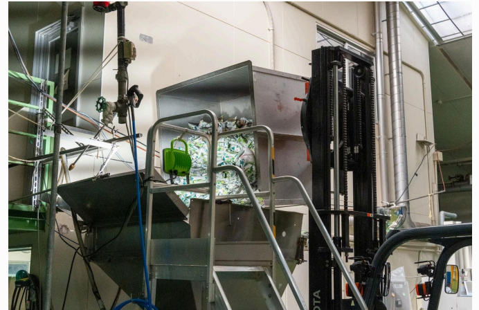
写真：回転フォークリフトでホッパーに投入される廃棄紙パック
