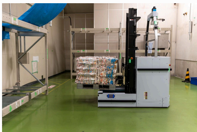
写真：圧縮梱包された分別後の紙バックは無人フォークリフトで運搬され売却される
