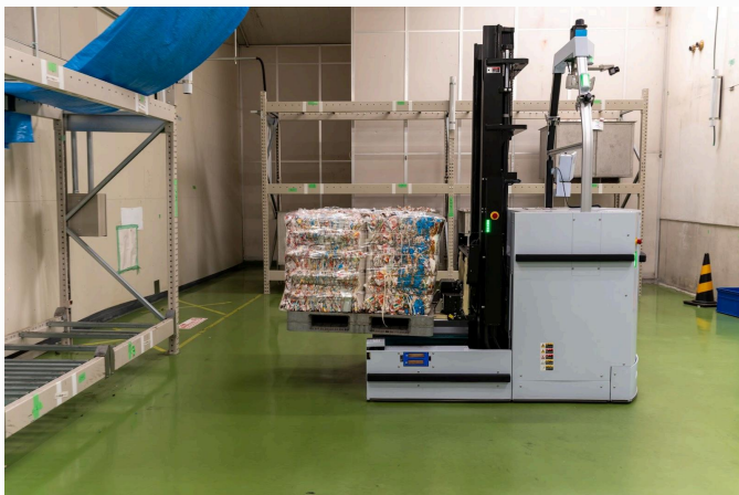
写真：圧縮梱包された分別後の紙パックは無人フォークリフトで運搬され売却される
