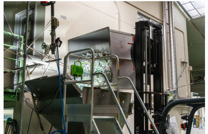
写真：回転フォークリフトでホッパーに投入される廃棄紙パック
