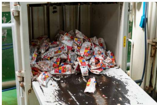
写真：分別機後段に設置された2台の圧縮機
