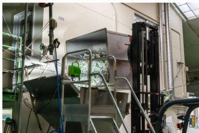
写真：回転フォークリフトでホッパーに投入される廃棄紙パック
